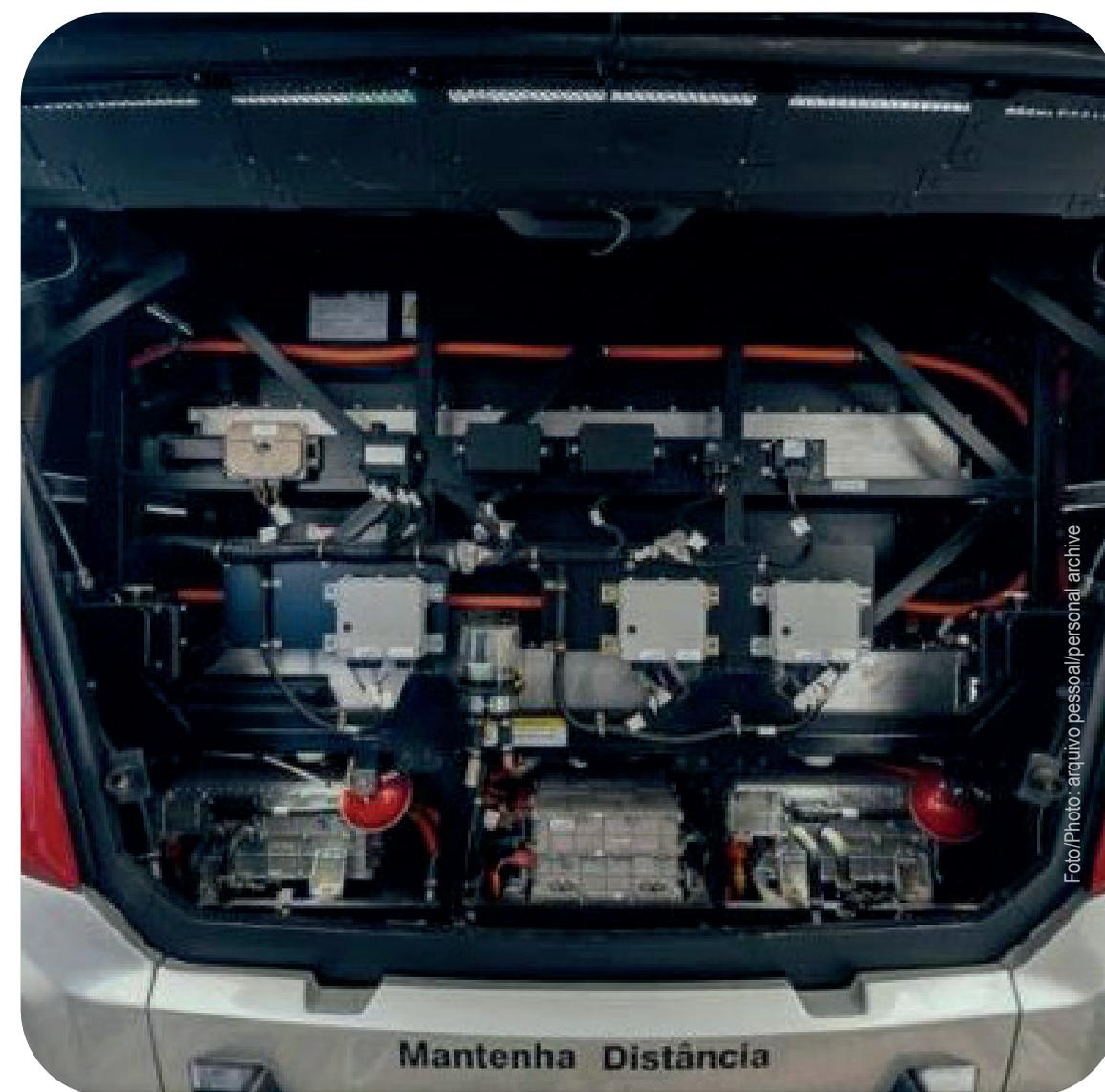
Espaço do conjunto de baterias e circuitos eletrônicos, instalados em ônibus elétrico
