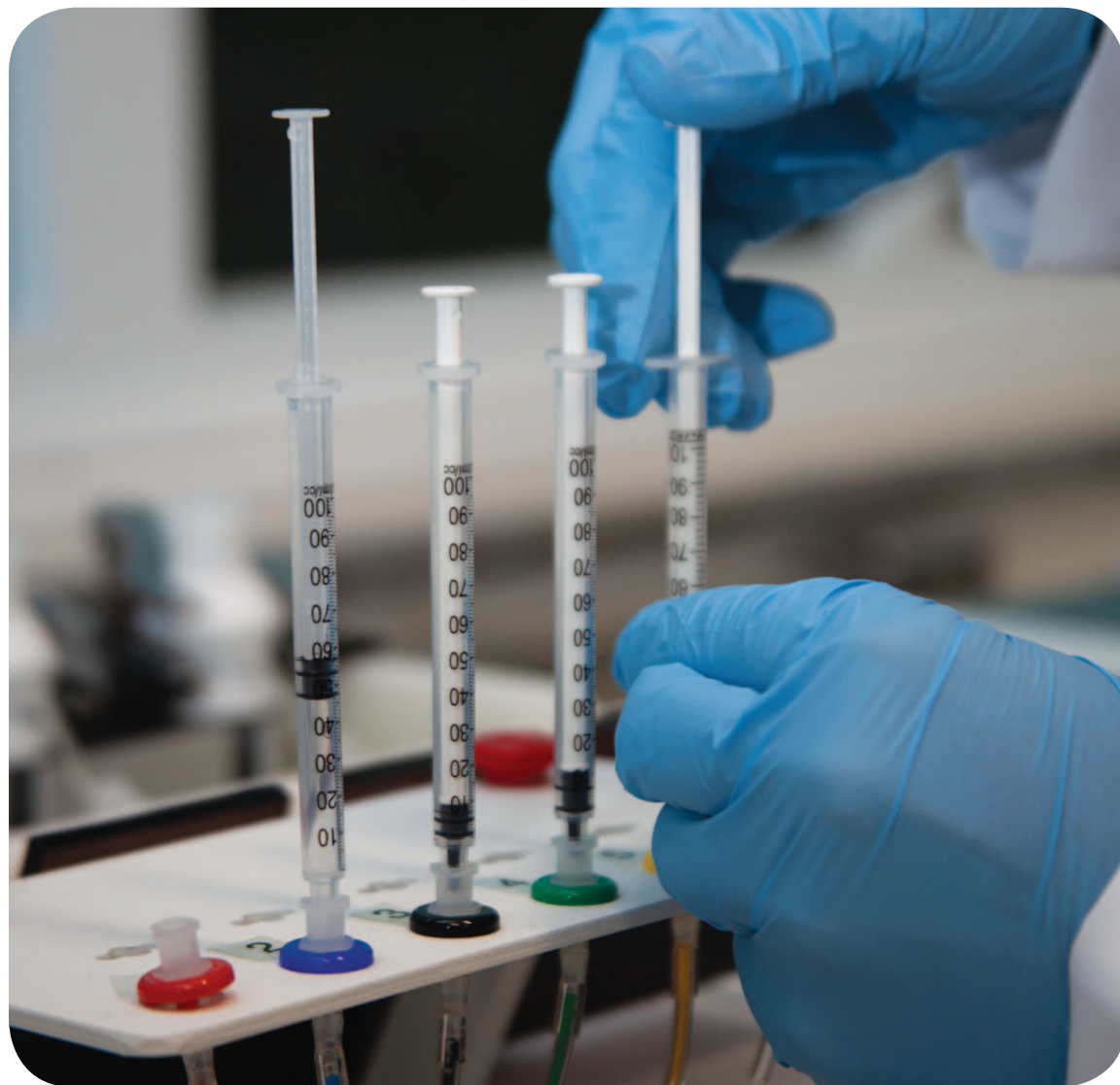
Equipamento científico em que foi testada a permeação transdérmica, usando-se pele de orelha de porco para simular a pele humana Scientific equipment through which transdermal permeation was tested, using pig ears' skin to simulate human skin
