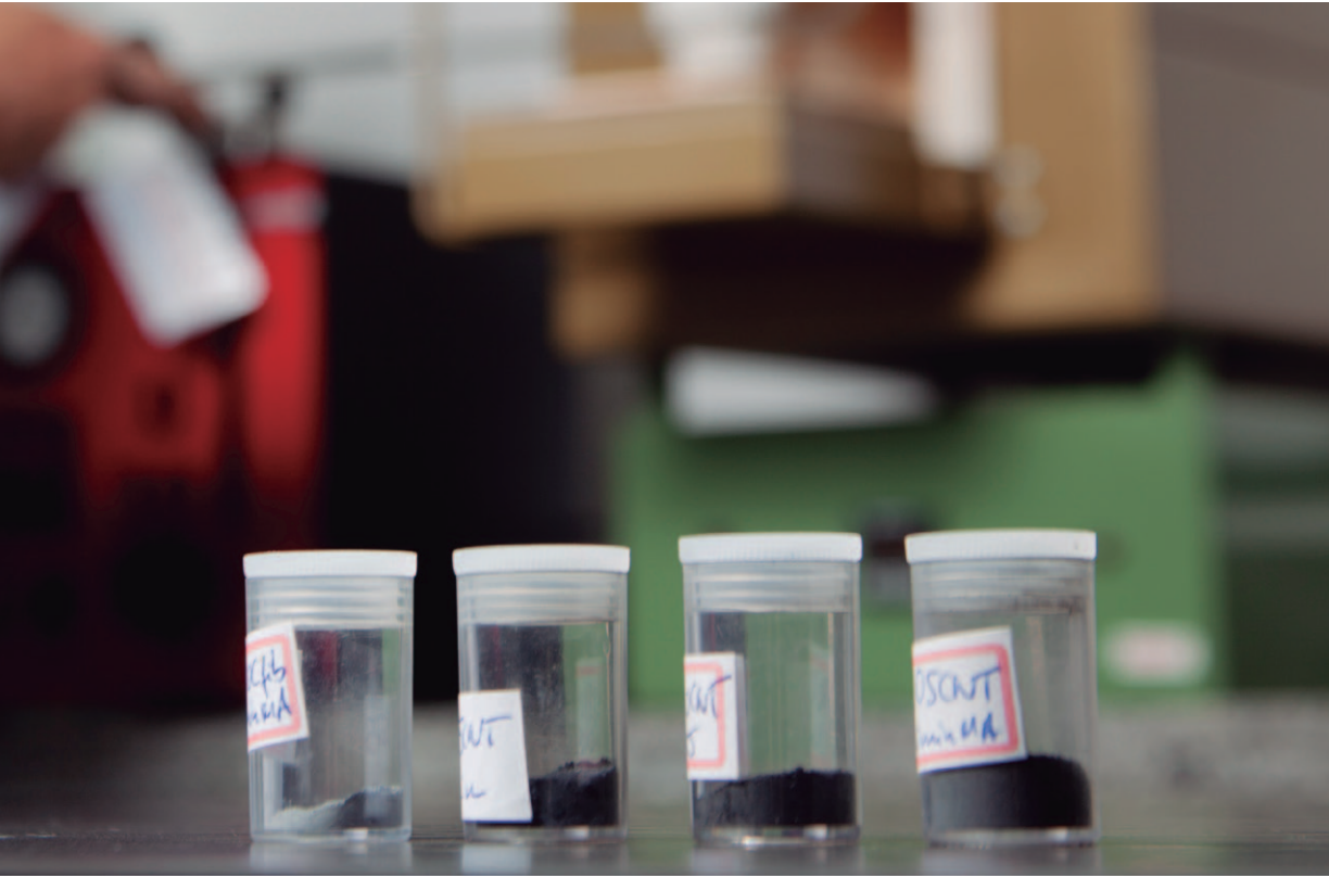
Aditivos como nanotubos de carbono e nanofibras de celulose (no detalhe) são adicionados à matriz cerâmica Additives such as carbon nanotubes and cellulose nanofibers are added into the ceramic matrix
