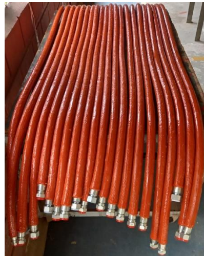
(d) Mangueira Flexível, Revestido com Isolante IT5004-4 Alta Temperatura > 300 °C Fonte: Elaboração própria (2025)
