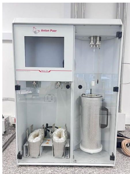
Figura 16 - Analisadores de área superficial BET e de volume e de diâmetro de poros(Anton Paar)
