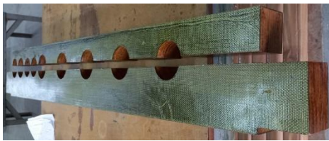
(c) IT5003-2 Fibra de Vidro com Resina Sintética Classificação térmica 155 °C (F)
