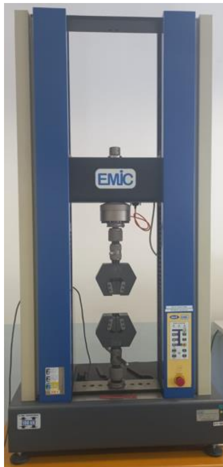
Figura 14 - Máquina de ensaio de tração Emic – Capacidade Máxima 100 kN
