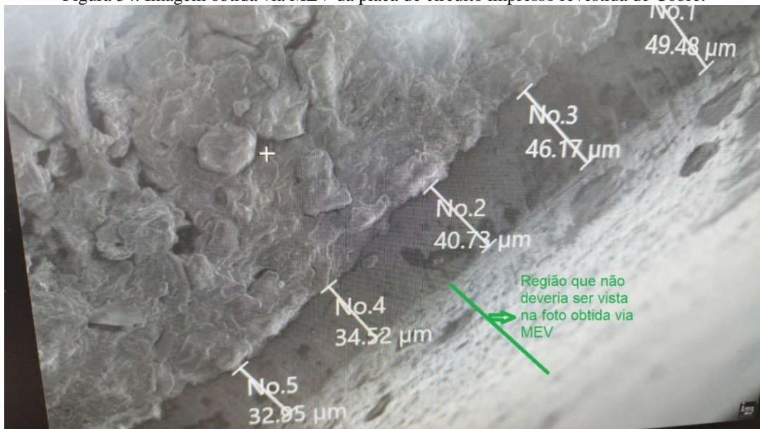
Figura 34. Imagem obtida via MEV da placa de circuito impresso revestida de Cobre.
