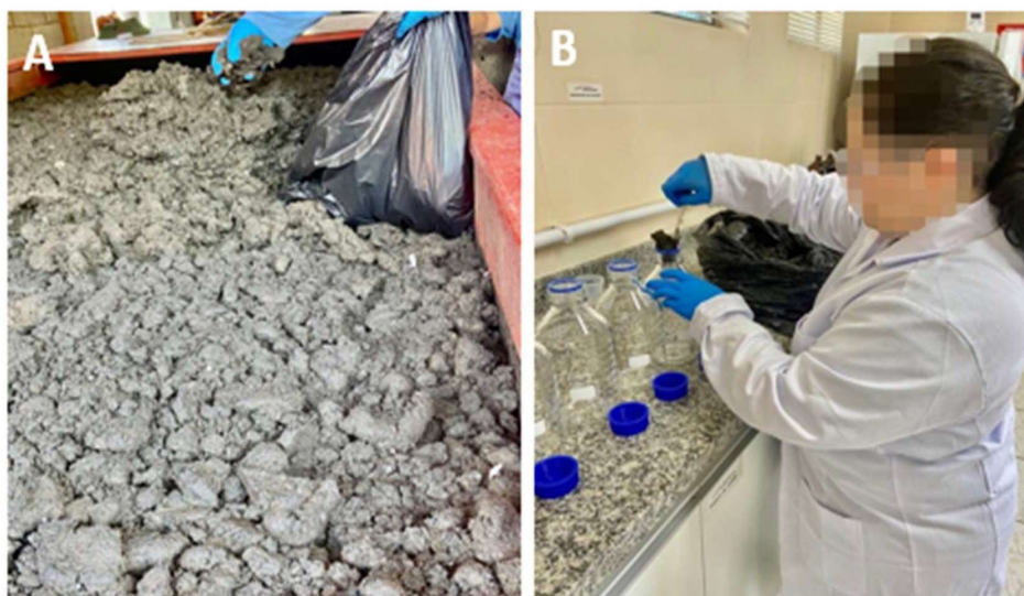
Figura 2 - Procedimento de coleta do lodo sendo em A a coleta de lodo realizada no ponto de descarte (armazenamento) na caçamba in loco na unidade; B as alíquotas de lodo sendo armazenadas nos recipientes para análise
