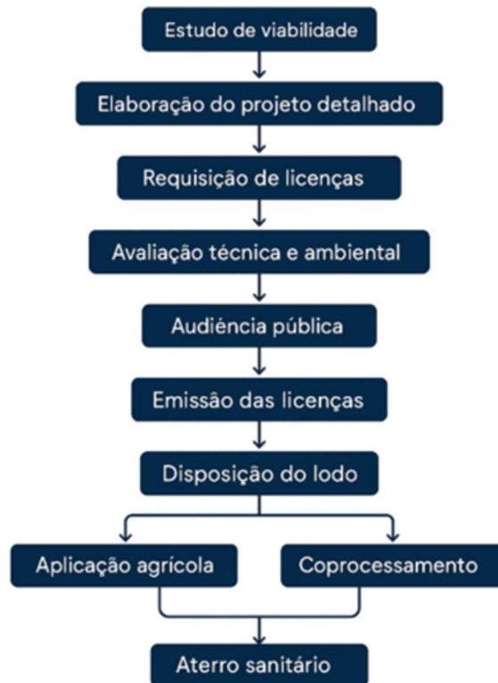
Figura 10 - Fluxograma resumo de licenciamento e disposição do lodo de ETE
