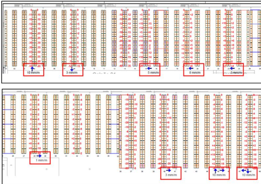
Figura 23 – Inclinação da estrutura
