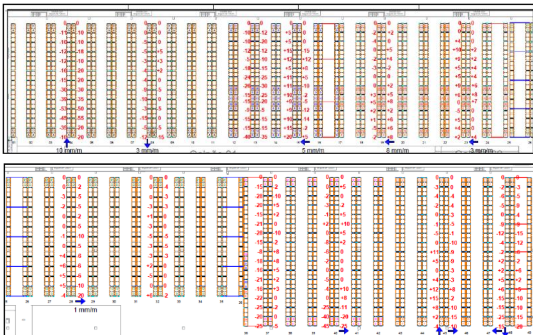
Figura 16 – Desnível da estrutura
