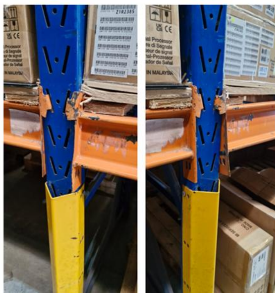
Figura 33 – Longarinas apresentando flexo torção
