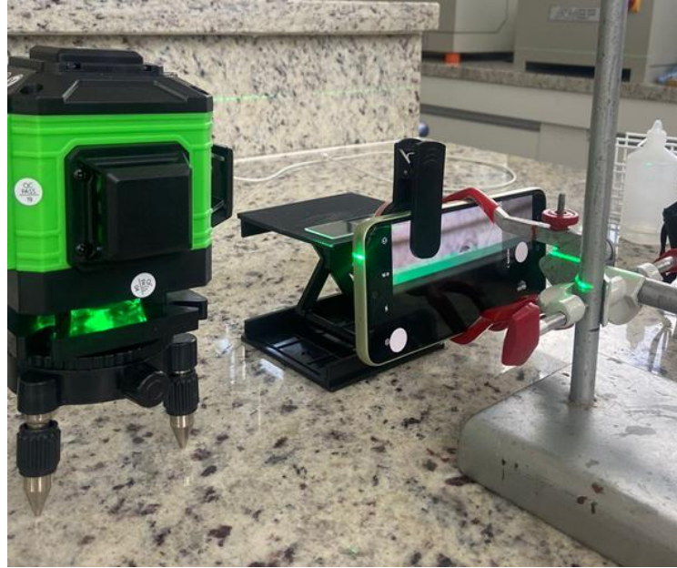
Imagem 2 – Sistema para análise de ângulo de contato dos filmes PET
