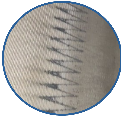
Figura 21 – Visualização de queima na emenda devido ao excesso de tempo de prensagem
