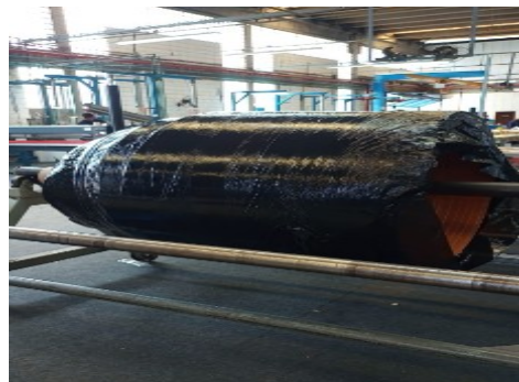
Figura 28 – Embalagem para proteção do rolo
