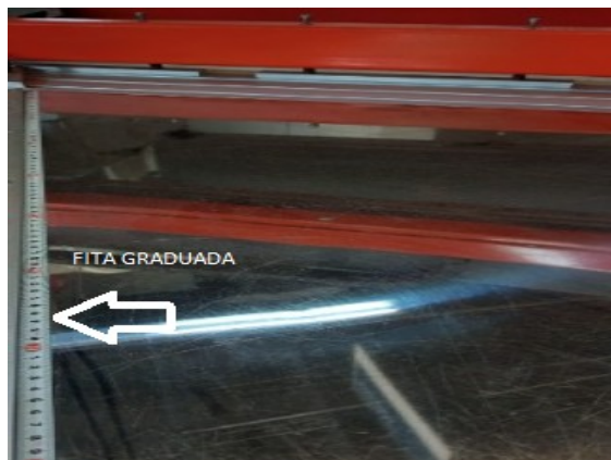
Figura 30 – Fita graduada adaptada na chanfradeira
