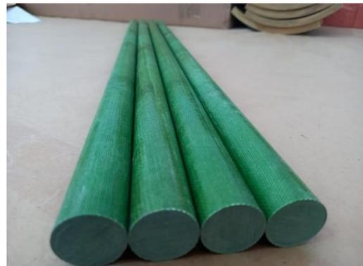
(d) Tarugo isolante composto fibra de vidro com resina termo-fixo
