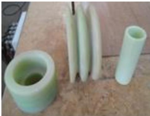
ITVE-Tecido Fibra de Vidro com Resina Epóxi
