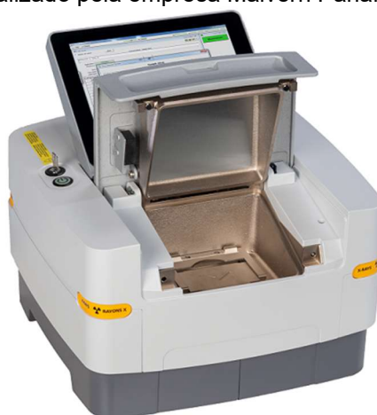
Figura 14 – Foto ilustrativa do modelo do equipamento de Fluorescência de Raios-X, Epsilon 1, comercializado pela empresa Malvern Panalytical Inc.
