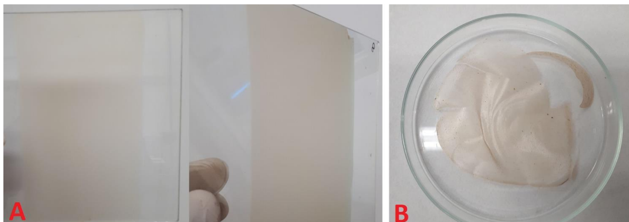
Figura 13 – Filmes produzidos através do amido da banana verde estendido em placa de vidro (A) e depositado em placa de Petri (B)
