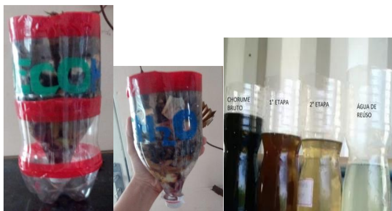
Figura 4 Filtro de chorume para demonstração.
