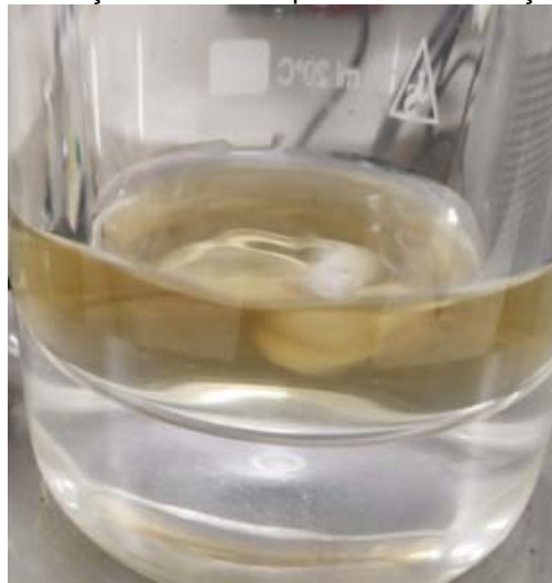
Figura 7 - Alteração de cor comprovando a formação de PANI
