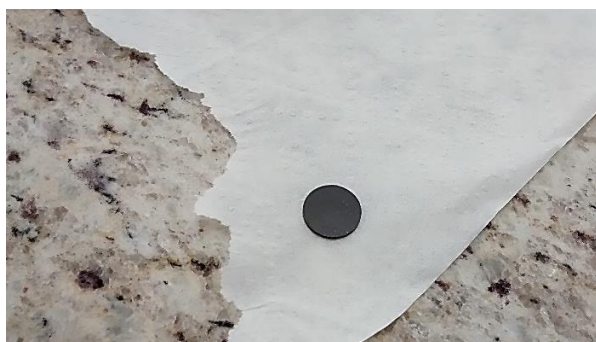
Figura 10 – Disco ou pastilha com o substrato e ácido bórico para análise de Fluorescência.
