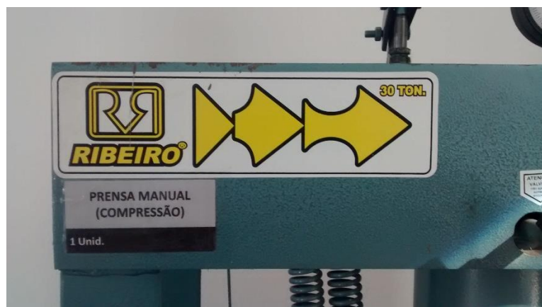
Figura 8 – Prensa para teste de resistência do substrato descartado
