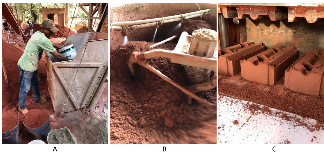
Figura 13 – Processo de produção do Tijolo Ecológico.
