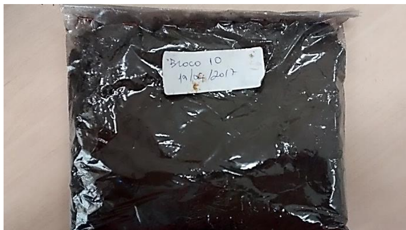
Figura 9 – Amostra de substrato após moagem em moinho de bolas.
