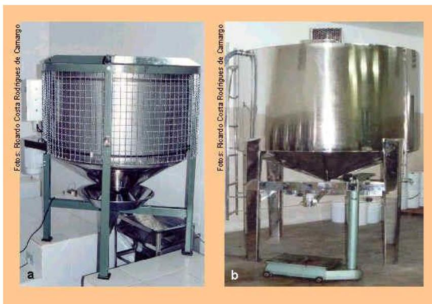
Figura 4 - Equipamentos utilizados na extração e processamento do mel: centrífuga (a) e tanque homogeneizador (b)
