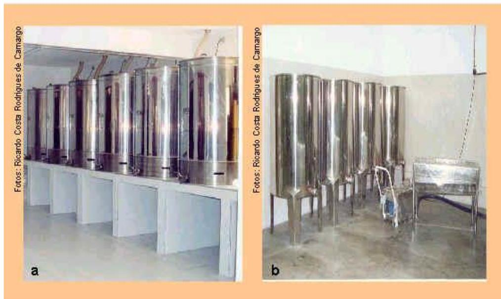
Figura 3 - Modelos de decantador (a), mesa coletora de mel e bomba de mel (b).
