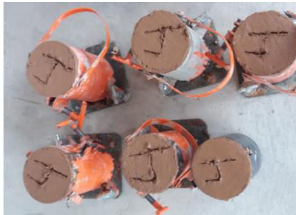
Figura 13 – Traço com 30% de pozolana.
