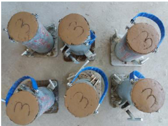
Figura 12 – Traço com 20% de pozolana.
