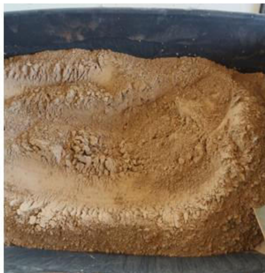
Figura 9 – Mistura do material pozolânico com cimento.
