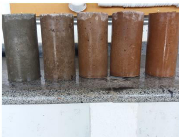
Figura 15 – Corpos de prova, variação da cor do traço 1 ao 5.
