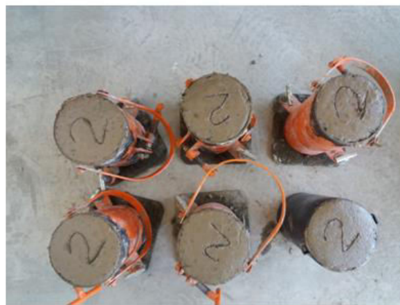
Figura 11 – Traço com 10% de pozolana.
