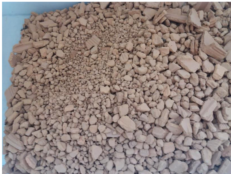
Figura 6 – Pré-moagem manual dos tijolos.
