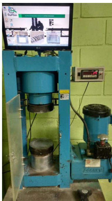
Figura 18 – Máquina para ensaio de resistência à compressão – Qualitec.
