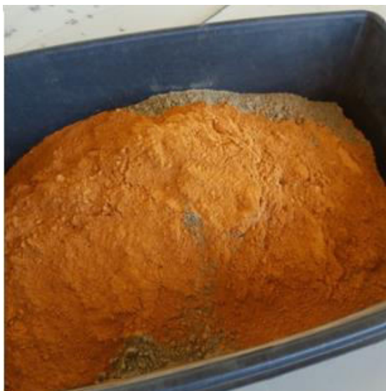
Figura 8 – Material Pozolânico sobre o cimento.
