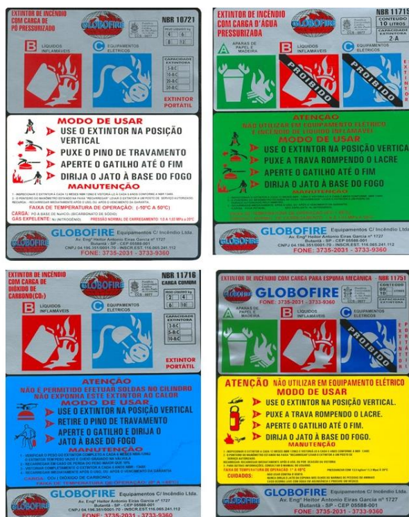
Figura 5: Rótulos de extintores Fonte: Elaboração própria
