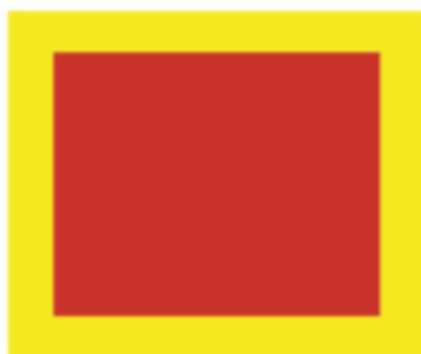
Figura 4: Sinalização de solo para equipamentos de combate a incêndio Fonte: (IT – 20, 2011).
