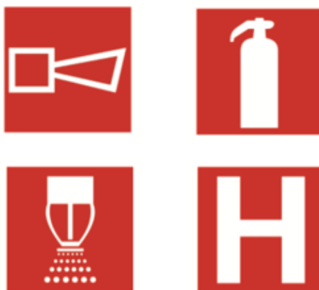
Figura 12: Sinalização de equipamentos e combate a incêndio Fonte: Adaptado de (IT 20, 2011).
