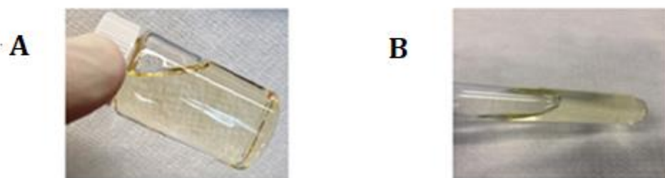
Figura 16 - Imagens para comparação visual da aparência (coloração e transparência) entre o geranato de colina produzido por Zakrewsky et al. (2016; A) e o obtido nesse trabalho (B).
