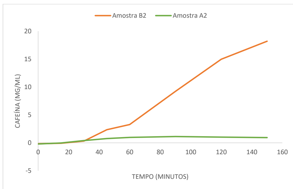
Figura 24 - Permeação de cafeína em estudo in vitro . Quantidade liberada ( \mu\text{g mL}^{-1} ) em função do tempo (minutos) a partir do gel com cafeína (formulação A2) e gel com cafeína e líquido iônico (formulação B2)
