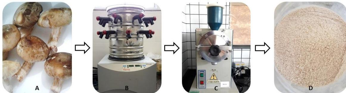
Nota: A: *Lentinus edodes in natura*. B: Liofilizador Termo Savant, LK-40. C: Moinho de facas e martelos. D: Pó do cogumelo seco e liofilizado.
