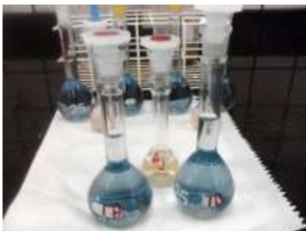
Figura 3- Comprovação da presença de compostos fenólicos (Método: Folin-Ciocalteu)
