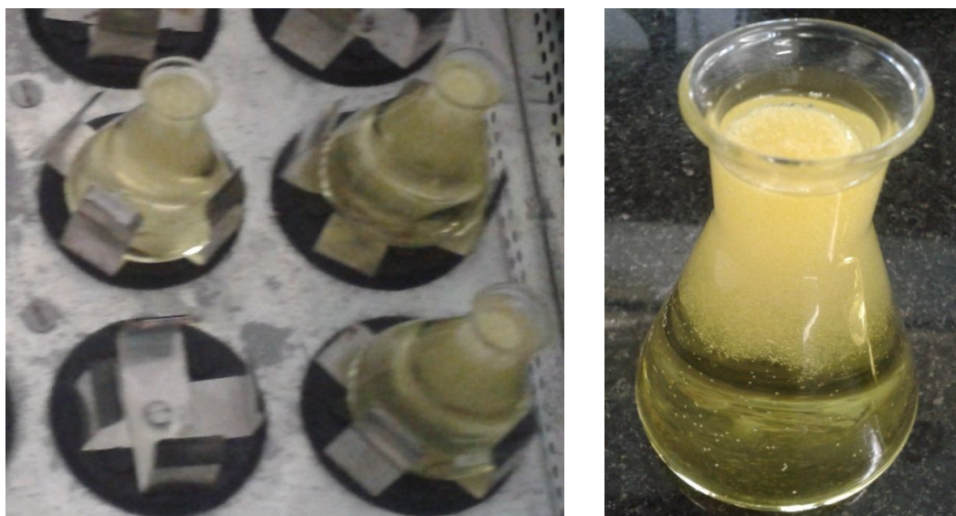
Figura 7. Solução de cloreto de cálcio com micropartículas de alginato de cálcio contendo nitrofurazona encapsulada, sob agitação orbital em câmara incubadora.
