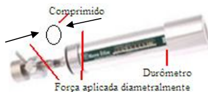
Figura 24 – Ilustração da força aplicada diametralmente
