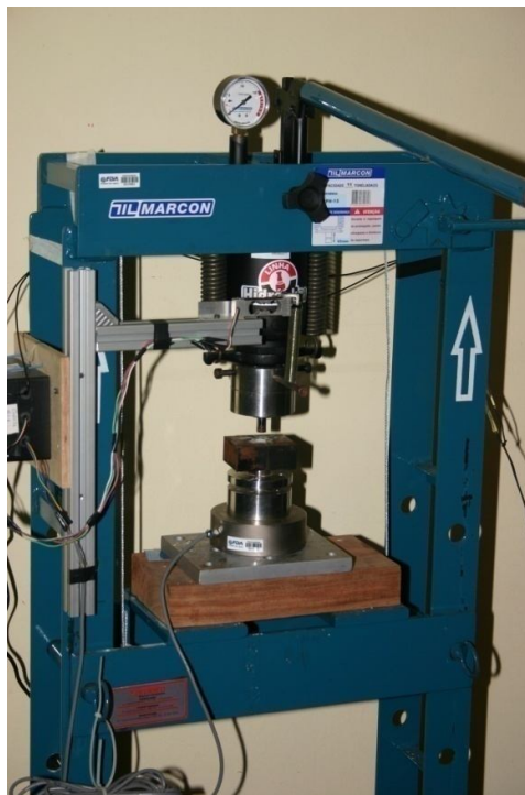
Figura 23 – Prensa hidráulica instrumentada (MCU), utilizada para a produção dos comprimidos
