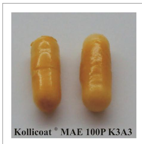
**Figura 30** - Fotografia das cápsulas de diclofenaco de sódio 50 mg revestidas com o filme Kollicoat® MAE 100P K3A3.
