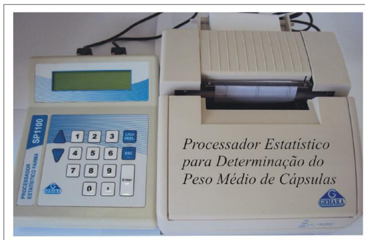
**Figura 13** - Fotografia do aparelho processador estatístico para a determinação do peso médio das cápsulas
