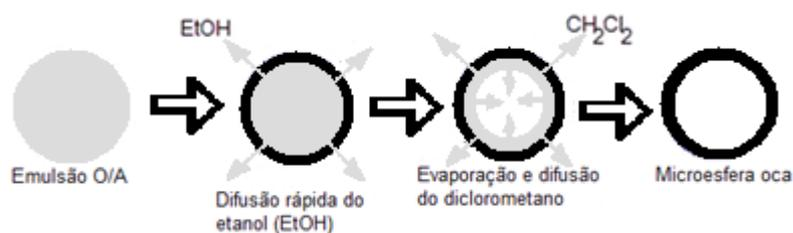
Figura 19: Mecanismo de formação dos *microballoons*.
