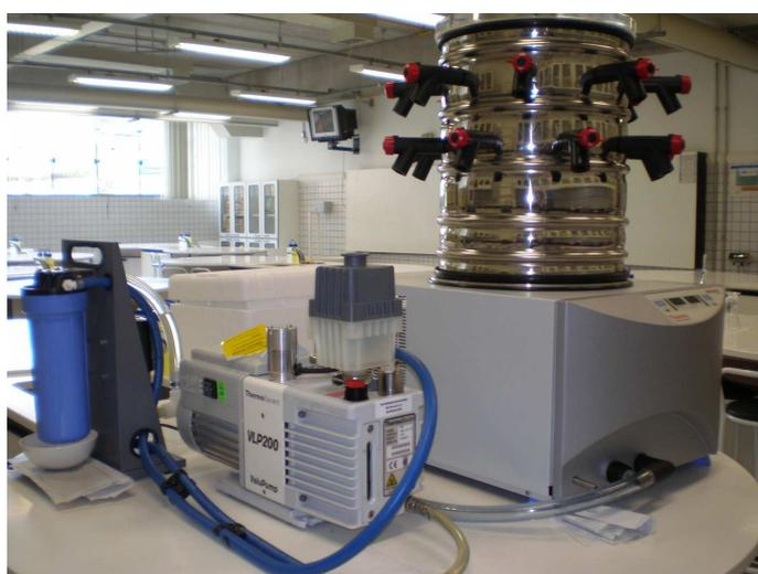
Figura 8: Liofilizador
