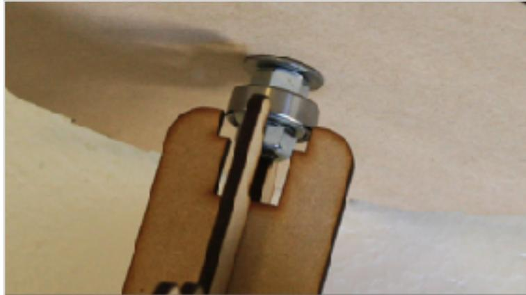
O rolamento é preso com porcas e parafuso na base giratória e encaixado na base fixa.
