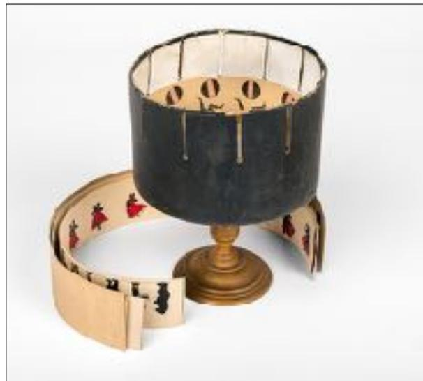
O zootrópio é um cilindro giratório com fendas verticais em sua lateral, apoiado numa base fixa. No seu interior é colocada uma tira alinhada horizontalmente, contendo uma sequência de imagens animadas. Ao girar o cilindro e olhar através das fendas, tem-se a ilusão do movimento das imagens. Disponível em <<http://www.cinematheque.fr/fr/catalogues/appareils/collection/zootrope-zootrope-ou-daedaleumcnc-ap-10-1039.html>>. Acesso em 30 de novembro de 2016.
